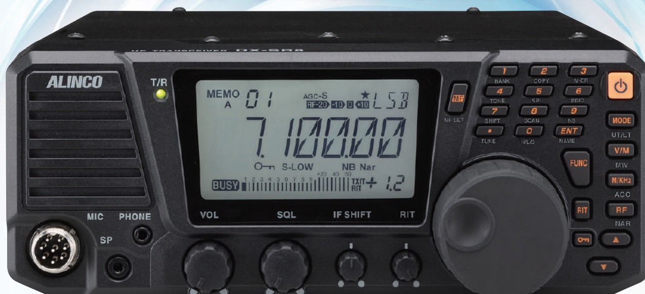
Ricetrasmittitore HF 100W All Mode
