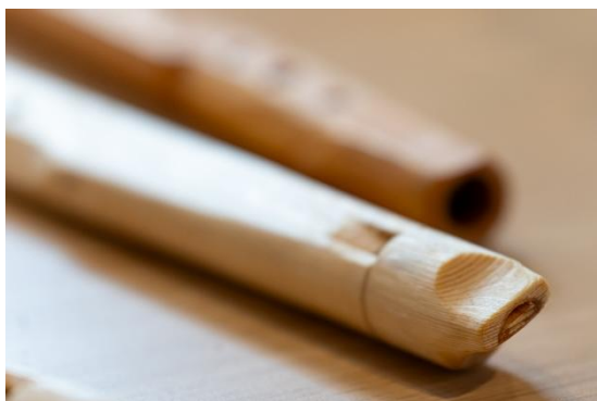
Figur 15: Munnstykke og lydhol er ferdig.
