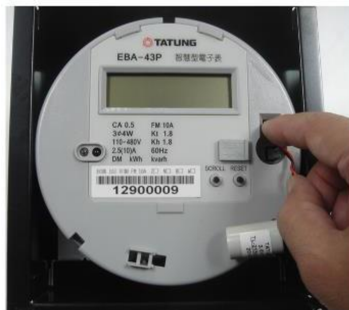
圖 6.3 電池安裝示意圖
