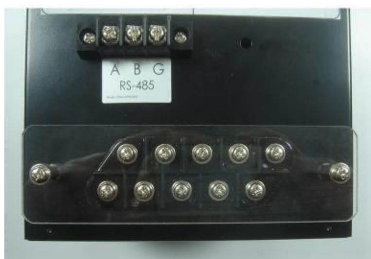
圖 6.2 電表背面端子照片
