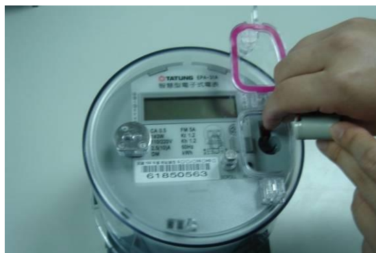
圖 6.3 電池安裝示意圖
