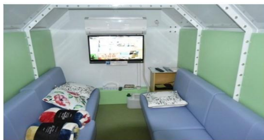
更酷的是這避難所極其小，但是空間內的設計卻是相當舒適，有電源、電視、沙發...等簡單傢俱，進入避難所後，會在短短 15 秒 - 45 秒內調整室內正壓到 1.07 個大氣壓，防止放射核物質和化學武器從外部入侵。
