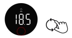
以按壓方式控制旋轉按鈕 Press the knob to control
