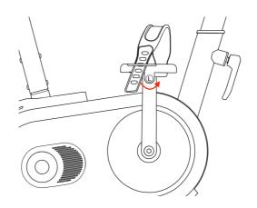
安裝腳踏橡膠綁帶: L標記配L腳踏, R標記配R腳踏。
