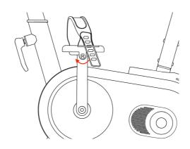
將印有 L 標記的腳踏裝進左邊的曲柄,用 15mm 開口扳手以逆時針(朝車頭方向)鎖 緊。
