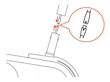
將插頭連接後,請將儀表管插入車架(步驟 1),然後將 4 顆 M6 螺絲分別裝入 4 個螺絲 孔,並用 4mm 內六角扳手鎖緊(步驟 2)。
