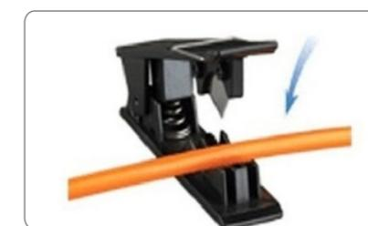
请使用管切刀切割PE管，请确认管尾有一个平整的切口，管切刀刀片适合使用于13mm以下的塑料管。
