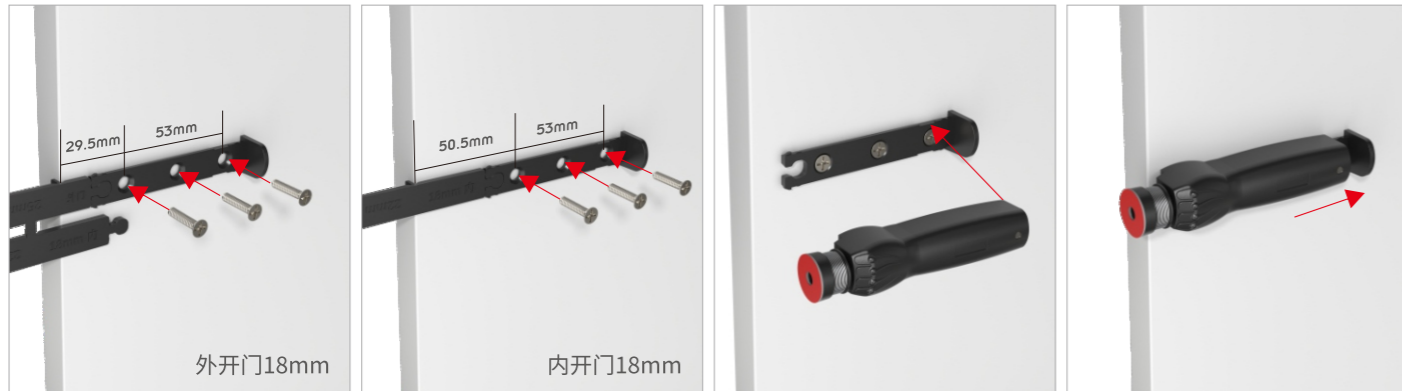
用专用定位器定位并安装螺丝
