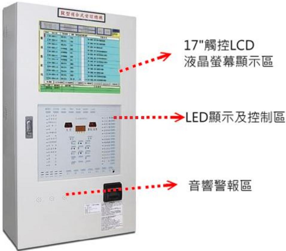
類比式 R 型(智慧型)系統為省工時、省配線式架構，係由 R 型受信總機、中繼器、類比定址探測器及附屬相關防災用設備所構成，一機同時兼具兩種系統控制功能者，稱 R 型複合式受信總機（多段式數位）。
