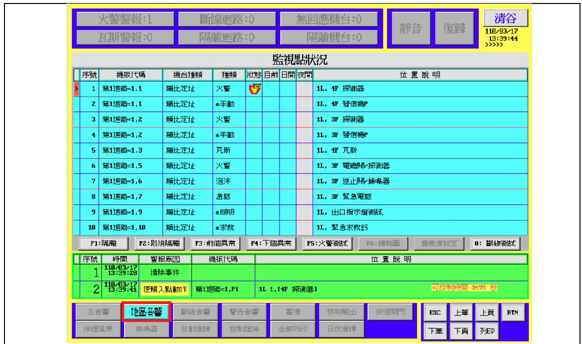
狀況二：當第一筆探測器動作，在將地區音響關閉時不會有倒數時間，但第二筆火警訊號出現地區音響開關直接輸出，警鈴輸出。(如上圖)
