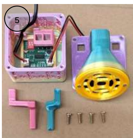
第五步、將喇叭線接於電路板，並且電源線須依圖式中，安置於左角落夾縫卡扣固定。
