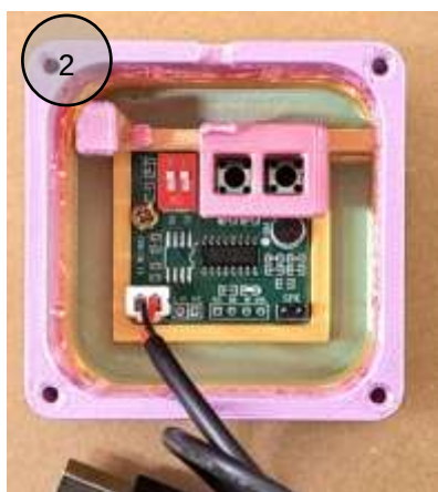
第二步、錄音板置於底座，並以 1 根 M3-15 螺絲鎖固。
