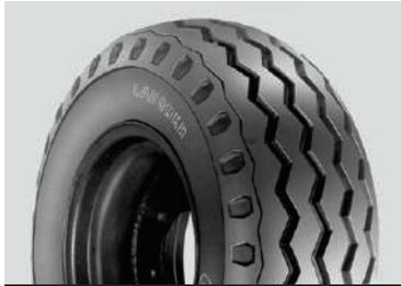
El neumático laborer de Goodyear cuenta con una carcasa robusta con entalladuras de anchos hombros lo que da excelente maniobrabilidad y reducción de la resistencia al avance y a los derrapes.
