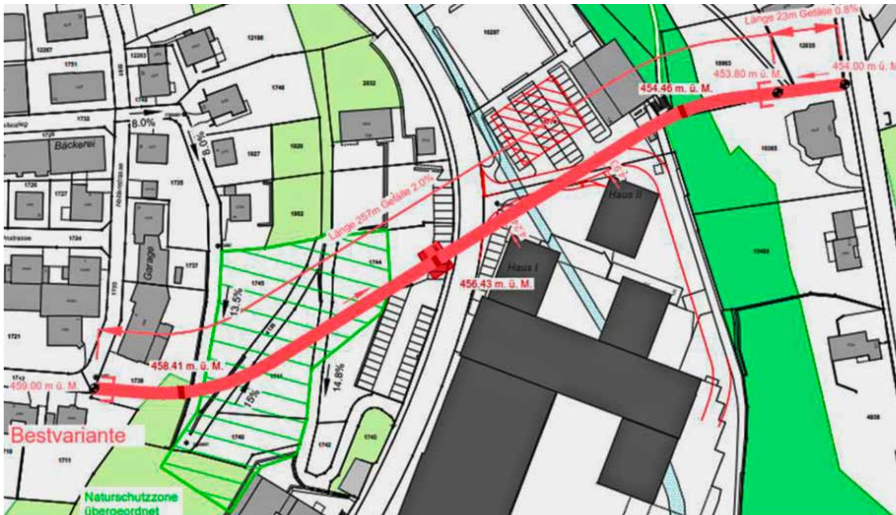
Die Linienführung der «Bestvariante» des Duraducts wurde auch aufgrund des Gefälles ausgewählt: Die Brücke würde so die Gartenstrasse auf der Schaffhauser Breite mit dem Weinsteig auf der Geissberg-Seite verbinden. Auf Höhe des nördlichen Endes der Stahlgiesserei gäbe es in einer Stütze einen Lift ins Mühlerental. KARTE STADT SCHAFFHAUSEN
