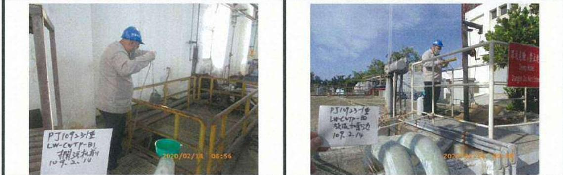
原污水(攔污機前): 採樣動作 109.02.14      放流水(放流加氯池): 採樣環境 109.02.14
