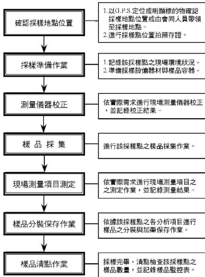
圖 2.4-2、廠內水質現場採樣作業流程圖
