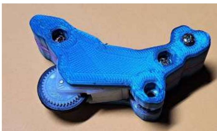
圖六、採用 2 根 M3x15 螺絲，先將上方兩個孔槽內螺母互鎖
