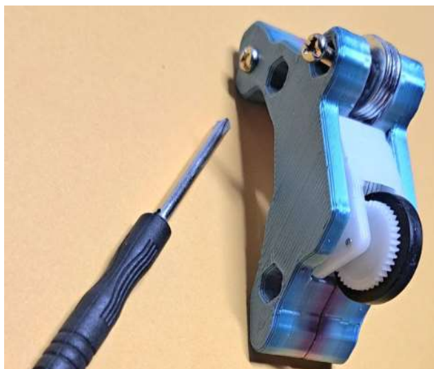
圖七、先將四個墊片置入前輪孔槽，再將 M3x15 螺絲穿入，與孔槽內螺母互鎖
