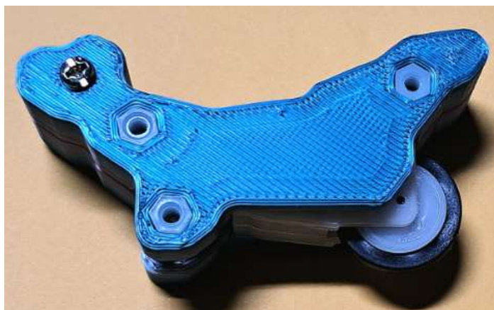
圖五、將 M3x5 螺母置入外車殼的孔槽內
