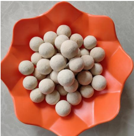
高鋁蓄熱球( \text{Al}_2\text{O}_3 75%)
