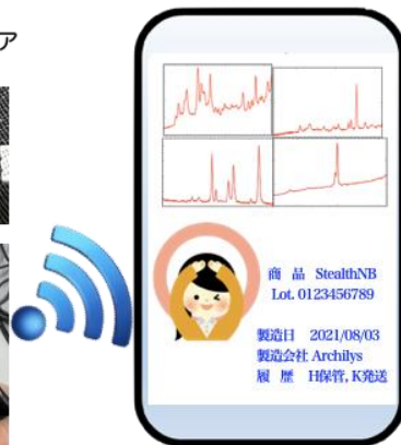
光シグナルのパターンをクラウドサーバーで照合して、真贋判定や商品情報を表示
