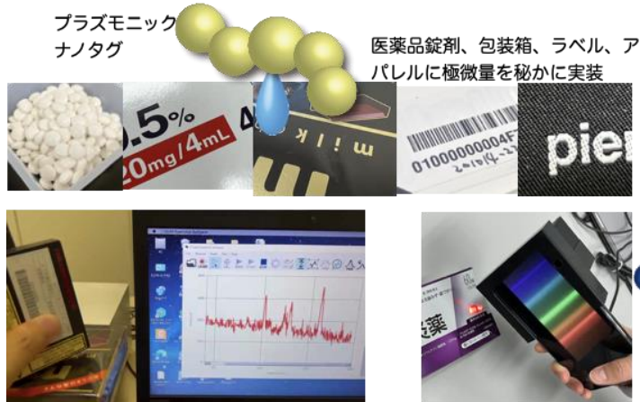
検出器でレーザーを照射すると特殊な光シグナルを発する
