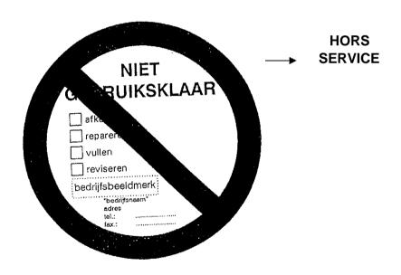
Image 4 - Exemple d'une étiquette indiquant qu'un extincteur est "hors service"
