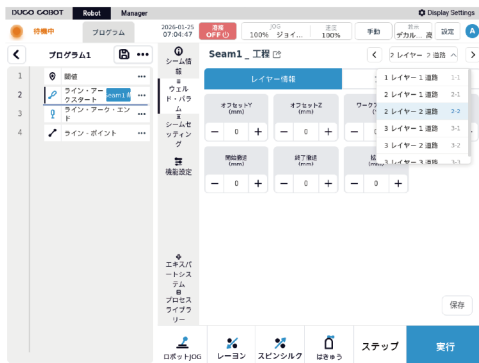
多層多道溶接
