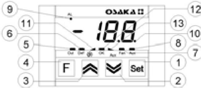
**1 – Tecla Set:** Permite configurar el Set Point y programar los parámetros de funcionamiento.
