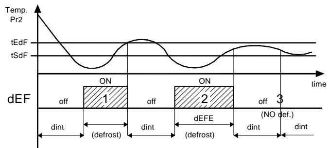
**Ejemplo:** el descarce 1 termina cuando se alcanza la temperatura "tEdF", el descarce 2 termina cuando se alcanza el tiempo "dEFE" si no se alcanza la temperatura "tEdF", el descarce 3 no se efectúa ya que la temperatura es superior a "tSdF".
