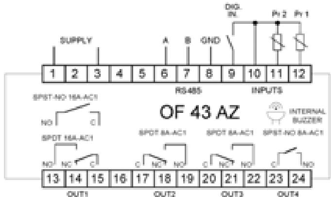
= **ALt** – Para controlar un dispositivo de alarma parable mediante un contacto normalmente abierto y cerrado en alarma.
