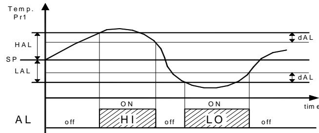
Las alarmas de temperatura de máxima y mínima se pueden desactivar programando los parámetros "HAL" y "LAL" = OFF. A la vez que salta la señal de alarma configurada (salida), el led AL se enciende, se apaga el led OK, se enciende el led - en caso de alarma de mínima o el led + en caso de alarma de máxima y se visualiza sobre el display:
