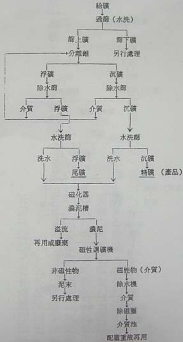
圖八十四 重液選礦流程圖（使用有磁性的介質）
