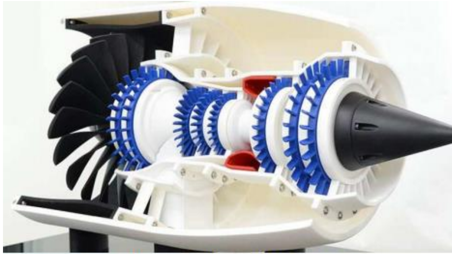
3D列印噴射引擎模型[34]
