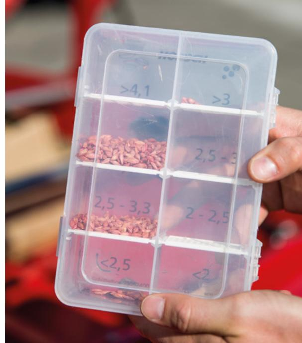
Mit der Grösse des kalibrierten Korns wird die Dosiertechnik eingestellt.
