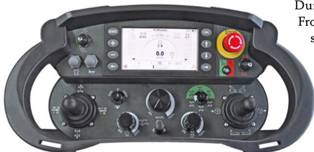
Der Metron wird mit einer Funkfernbedienung gesteuert. Bild: zVg
