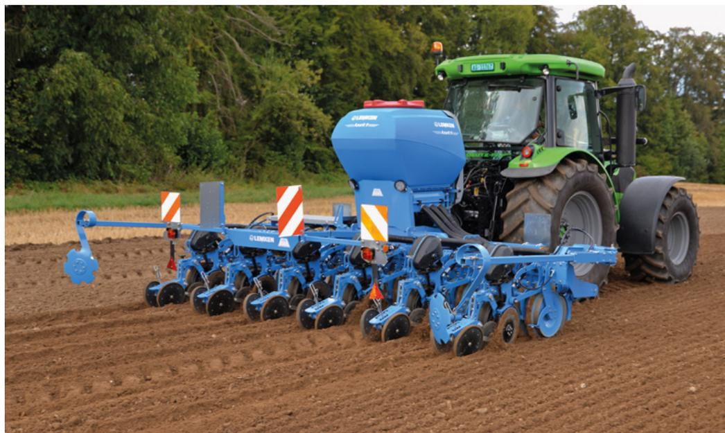
Jeder Säschar verteilt die Körner auf zwei Reihen mit einem Abstand von 12,5 cm. Der dadurch erhöhte Pflanzenabstand verbessert den Zugang zu Licht und Nährstoffen.
