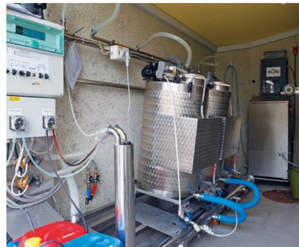
Ein Anbau auf dem Betrieb der Familie Peter in Steffisburg BE war notwendig, um die ganze Anlage unterzubringen. Die Spülstation (vorne) reinigt die beiden Wechsel-Tanks (Mitte) und den Pasteur (hinten).
