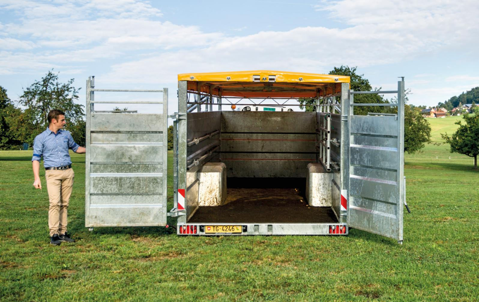
Der Transportanhänger läuft dank der öl-pneumatischen Aufhängung so ruhig, dass die Tiere während der Fahrt einen sicheren Stand haben. Ein gegossener Gummiboden gibt speziell guten Halt.
