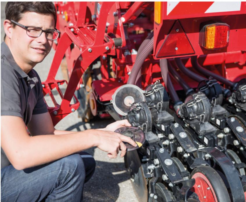
Reto Maugweiler von der Agrar Landtechnik AG mit dem geöffneten Dosiergerät, das die Getreidekörner vereinzelt.
