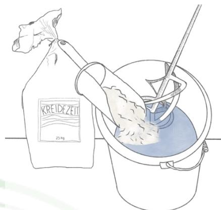
2. 將粉加入水中用電動攪拌機攪拌均勻 (比例約 1kg 粉 : 300-350ml 水)
