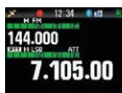
Ricezione SSB nella banda HF (l'icona PTT indica la banda operativa)
