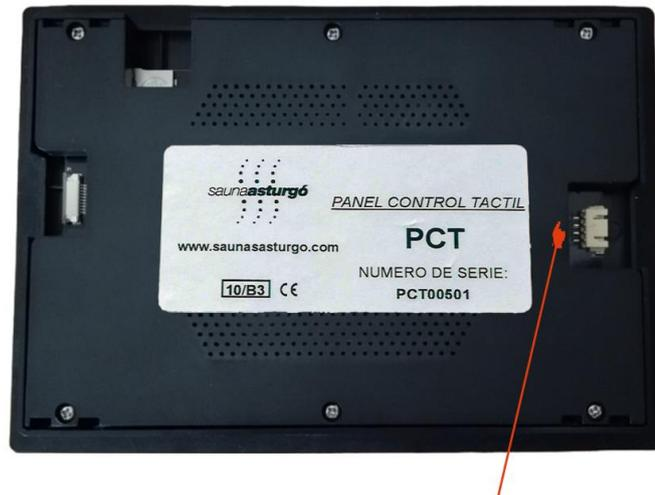
Conexión del cable que proviene de la placa electrónica
