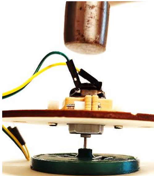
圖八、利用鐵鎚打擊馬達軸，並敲擊後可使慣性輪與馬達軸固定
