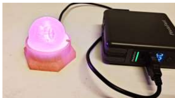
圖十二、完成成品，接著找電源測試(使用 5V1A 即可點亮)
