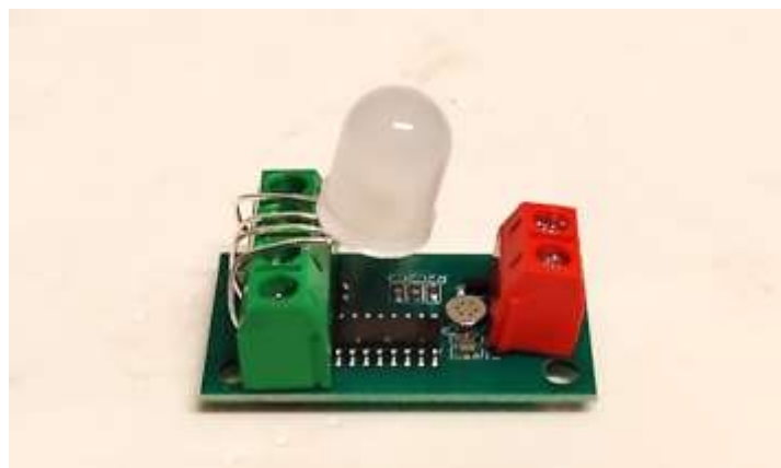
圖五、當鎖固後，依照此四步驟將 RGB-LED 燈凹 90 度立起來
