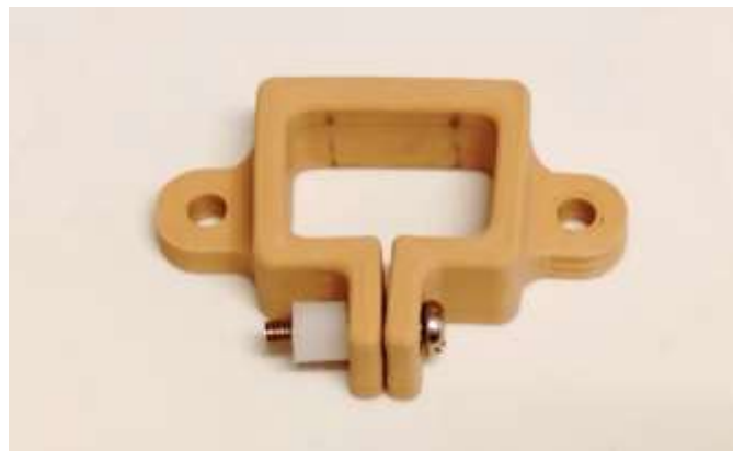
圖四、長螺絲與螺母互鎖，先不用鎖到全緊
