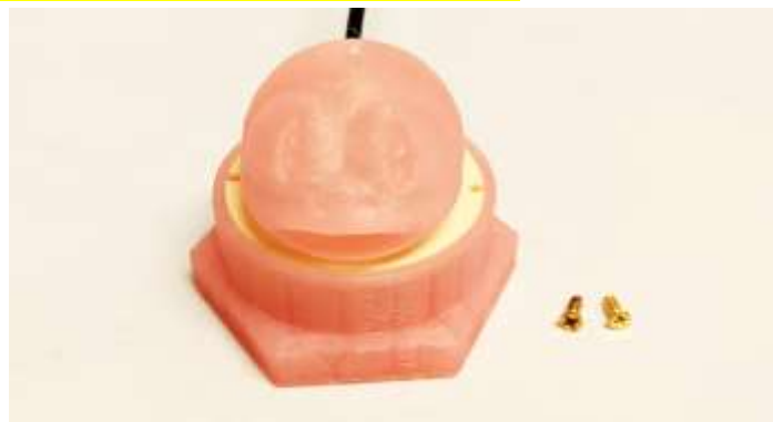
圖十一、將上部燈罩與下半燈座以螺絲鎖固
