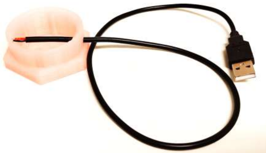
圖六、將電線先穿過底座圓孔
