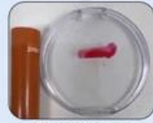
等離子處理後 處理後增加親水性和附着力， 達因筆測試均勻鋪開
