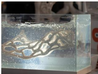
Soliquid est spécialisé dans le domaine de la fabrication additive pour les industries AEC et du Design, et développe un procédé unique d'impression 3D grande échelle en suspension dans une matrice de gel réutilisable et durable.
