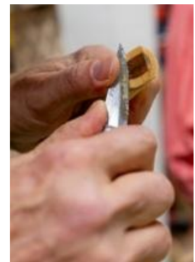
Kuva 4 a–d. Huilun Ikkunan, tulpan ja puhalluspään muotoilun vaiheita.
