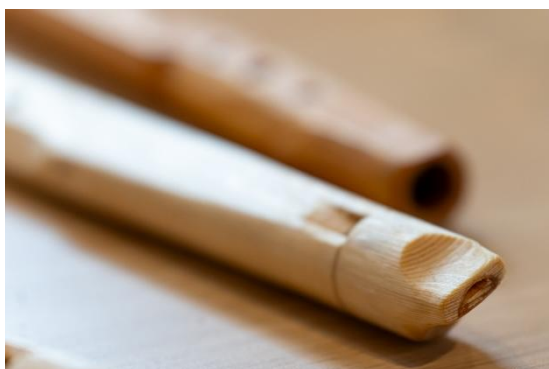
Figur 7: Munnstykke og lydhol er ferdig.
